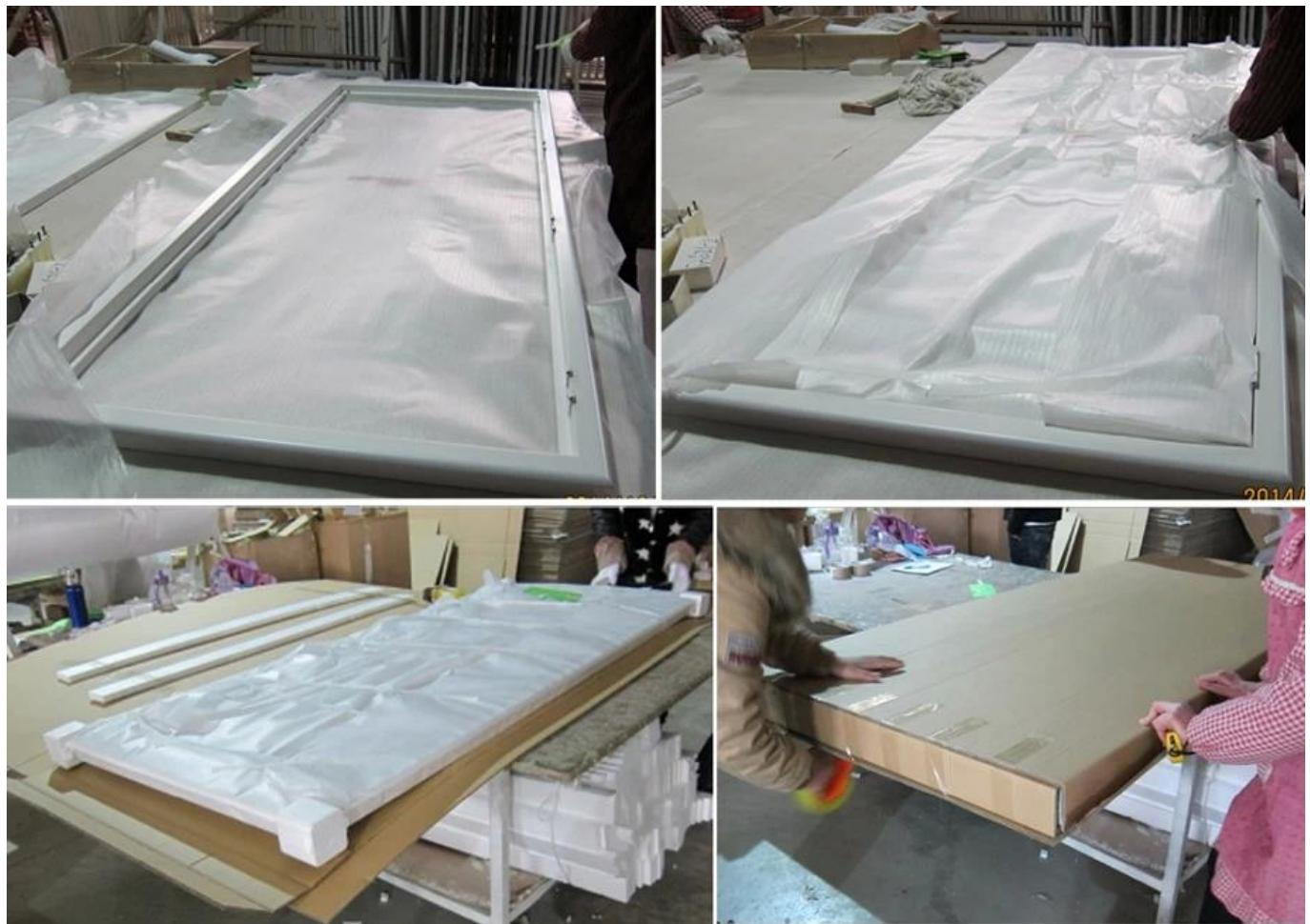
**В.** Для затворов с более чем двумя панелями, панелями и каркасами, упакованными в отдельности.
