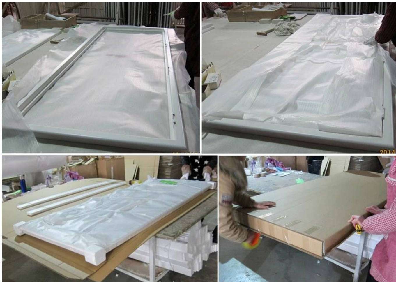
B. Para persianas com mais de dois painéis, painéis e molduras embalados separadamente.
