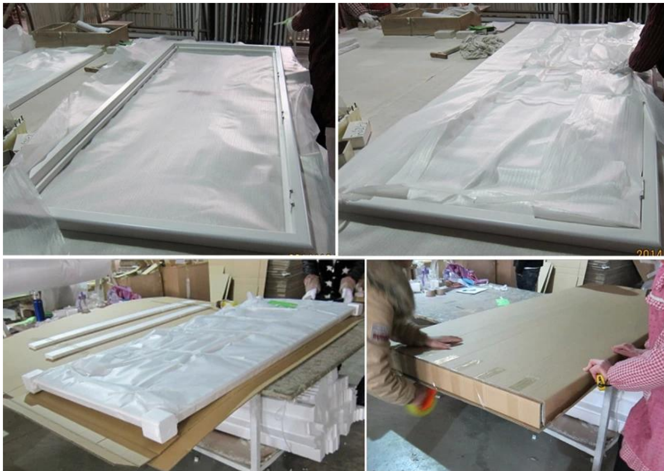
B. W przypadku żaluzji z więcej niż dwoma panele, panele i ramki pakowane oddzielnie.
