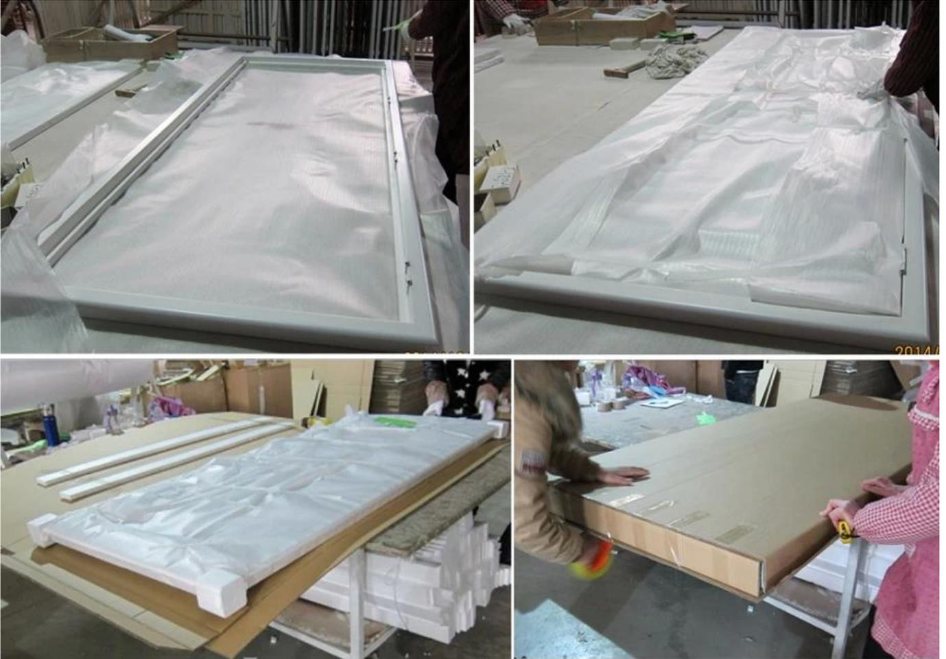
**B.** Für Fensterläden mit mehr als zwei Platten, Paneelen und Frames separat verpackt.
