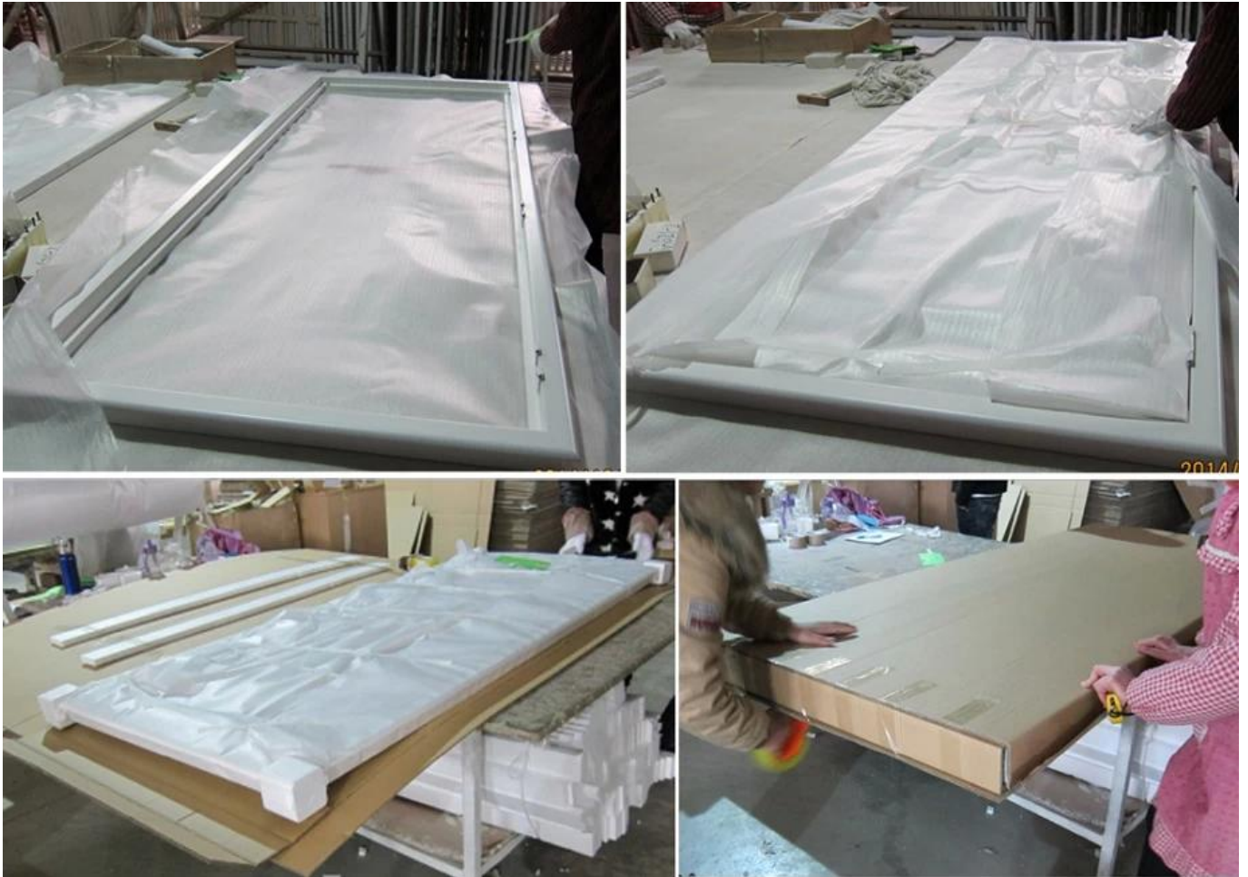
B. Für Rollläden mit mehr als zwei Tafeln, Tafeln und Rahmen verpackt separat.
