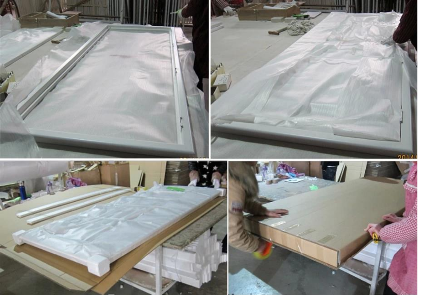
B. Für Fensterläden mit mehr als zwei Platten, Paneelen und Rahmen separat verpackt.
