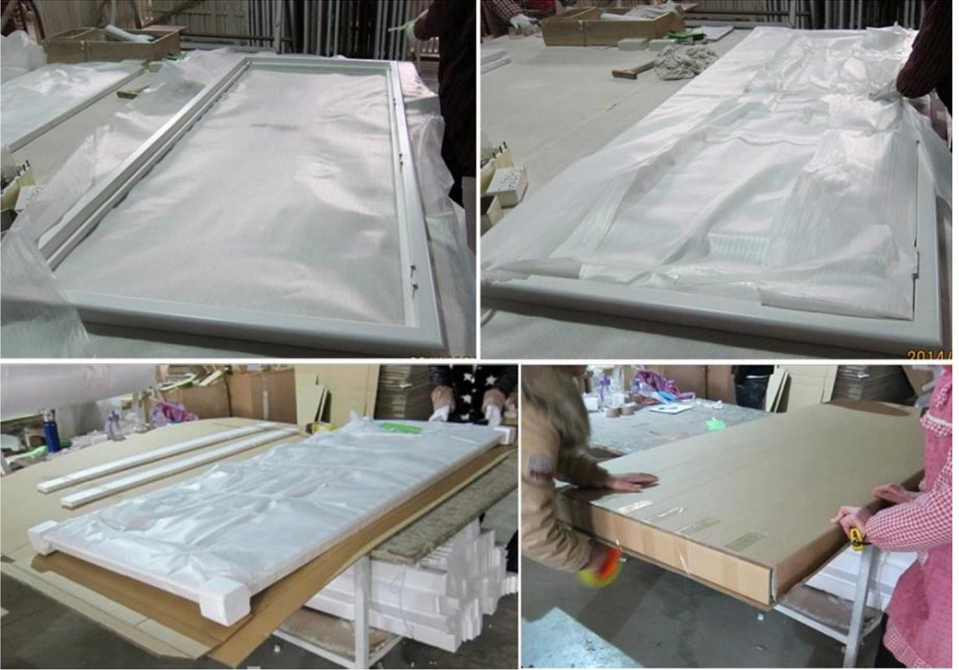
**B.**Für Klappen mit mehr als zwei Platten, Paneelen und Rahmen getrennt verpackt.
